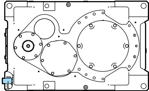
Réchauffeur d'huile à visser avec capteur de température et thermostat
