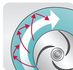
Une roue conventionnelle projette les particules sur la volute.
