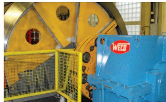
Réducteur WECO entraînant la roue de traction du Funiculaire
