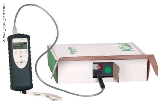
Configuration d'un variateur Altivar 320 dans son emballage : VW3A8121 + cordon VW3A8126
