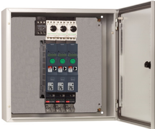
Exemple de montage direct GV2/ATV320 dans un coffret : disjoncteurs GV2L + accessoires GV2454 et GV2G05 + variateurs ATV320U15N4B
