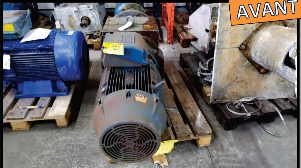
Démontage, nettoyage, contrôles visuels, contrôles métrologiques, contrôles électriques, remplacement du moteur, remplacement des roulements réducteur, du train d'engrenages en entrée, des joints, mise en huile, essai sur banc puis mise en peinture.
