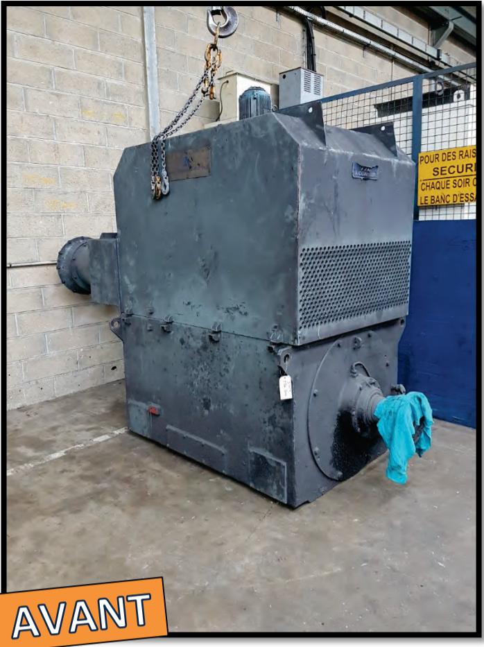
Révision d'un moteur Ansaldo 630kW 6 pôles, dépollution, contrôles visuels, contrôles électriques, contrôles métrologiques, remplacement des roulements et des joints, passage au banc d'essai, mise en peinture puis livraison par nos soins avec notre poids lourd.
