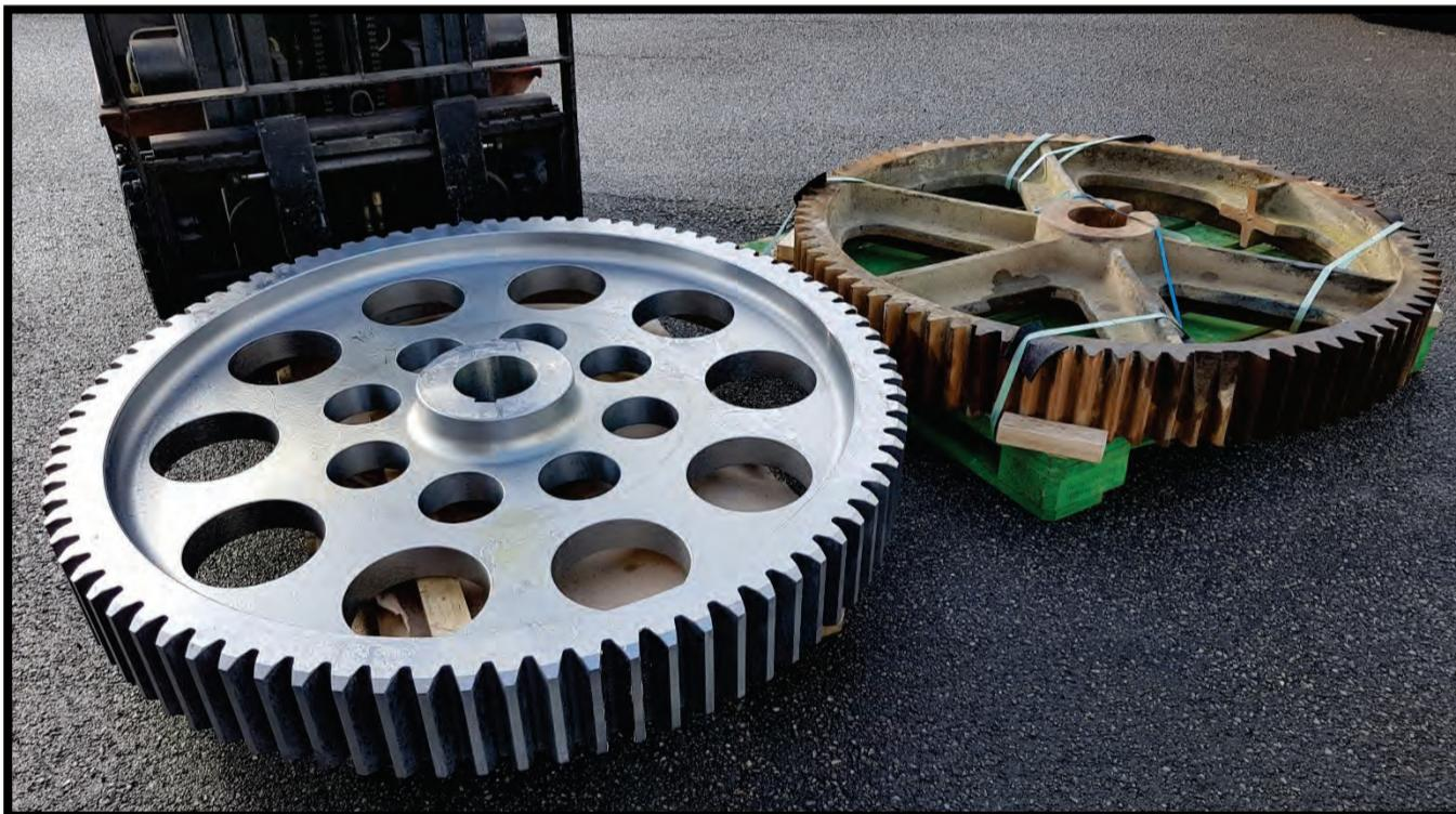
Réalisation d'une roue de réducteur 89 dents module 16, engrenage taillé pleine masse dans un rond forgé, selon modèle cassé – Taillage qualité 9 iso 1328, certificat avec analyse chimique, dureté et contrôle dimensionnel.
